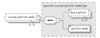
Figure 6-8. The <custom-portlet-mode> XML Schema
